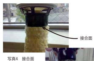
6) スピーカーユニットを交換し、外したときと逆の手順で組み付けていきます。
